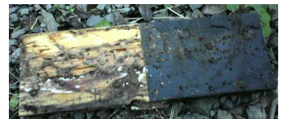
野外耐蟻試験結果 塗面食害なし
